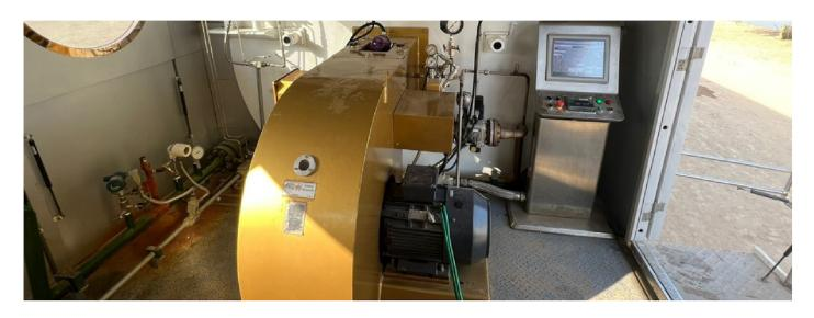
Nakasawa incorpora un quemador de alta eficiencia, equipado con mecanismos precisos de control de combustible-aire y controles VFD mediante software que garantizan una combustión completa. Este quemador de alta eficiencia reduce efectivamente la emisión de gases de efecto invernadero, contribuyendo a una operación más respetuosa con el medio ambiente.
